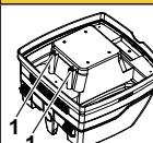
Die Wasserstandssensoren (1) regelmäßig reinigen und auf Anzeichen von Beschädigung untersuchen.
