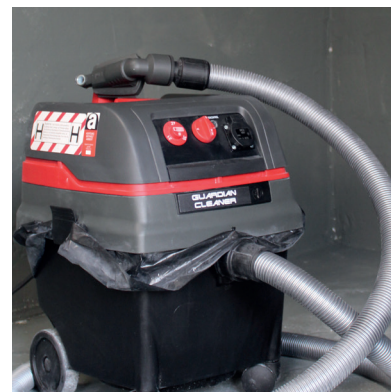
1. Starmix Bohrfixx Adapter auf den Guardian Cleaner stecken
